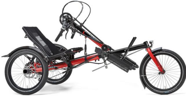
Handbike mit High Tech: der Heckantrieb sorgt auch an Steigungen für sichere Traktion.
