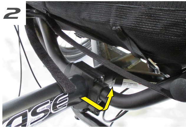
Schritt 2: Führen Sie den Klettverschlussriemen um die vorderen Enden des Sitzgestells herum, spannen Sie diesen und befestigen Sie ihn mit dem Klettverschluss. Step 2: Embrace the velcro strap over the bottom end of the seat frame, pull it and adjust it.
