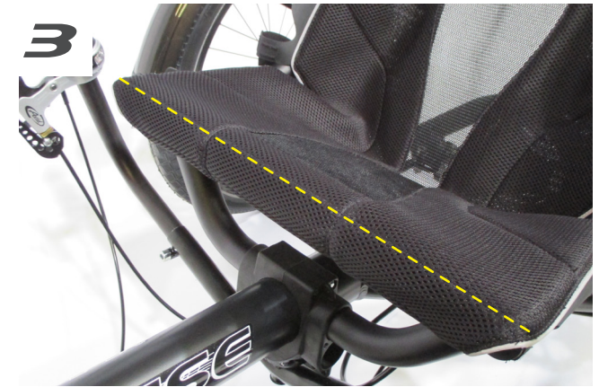
Schritt 3: Schließen Sie die vorne am Sitz liegende Lasche. Achten Sie darauf, dass sie mittig und gleichmäßig zum Rahmen ausgerichtet ist. Step 3: Close the bottom flap of the seat and make sure that it is centered and aligned with the seat frame.
