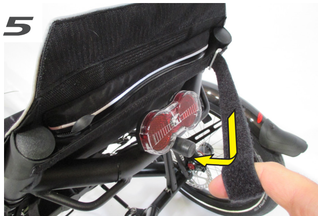
Schritt 5: Führen sie den Klettverschlussriemen um die oberen Enden des Sitzgestells. Spannen Sie den Riemen und befestigen Sie ihn mit dem Klettverschluss. Schließen Sie die Lasche. Step 5: Embrace the velcro strap over the top end of the seat frame, pull it and adjust it. Close the top flap of the seat.
